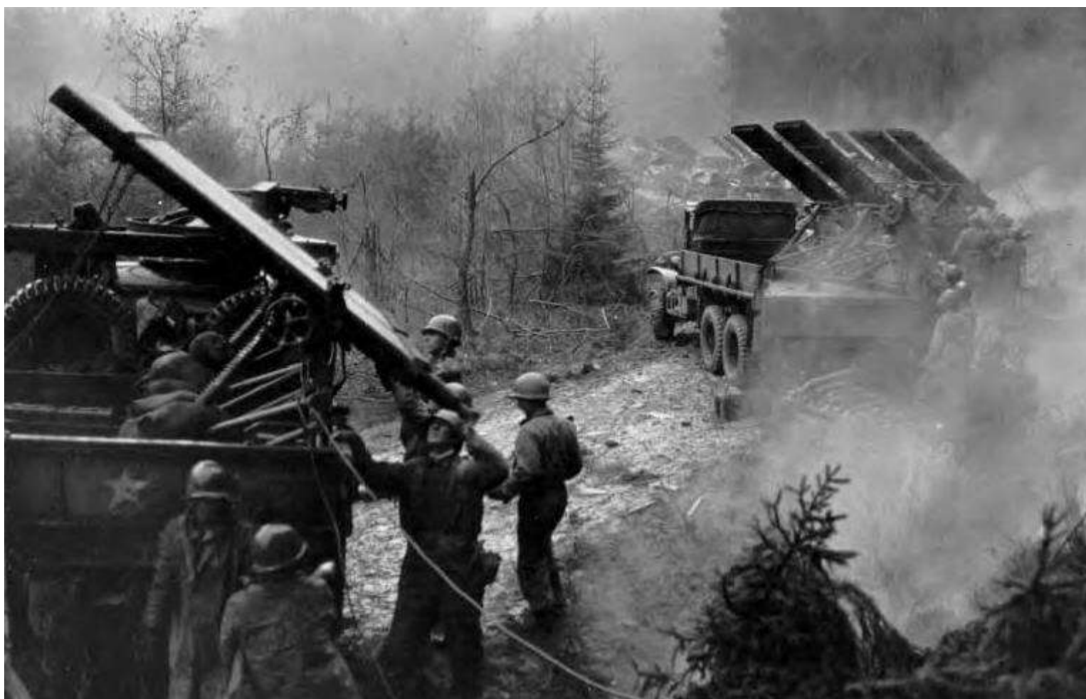
CCKW 353 s raketometem T-27 "xylophone" na své ložné ploše
