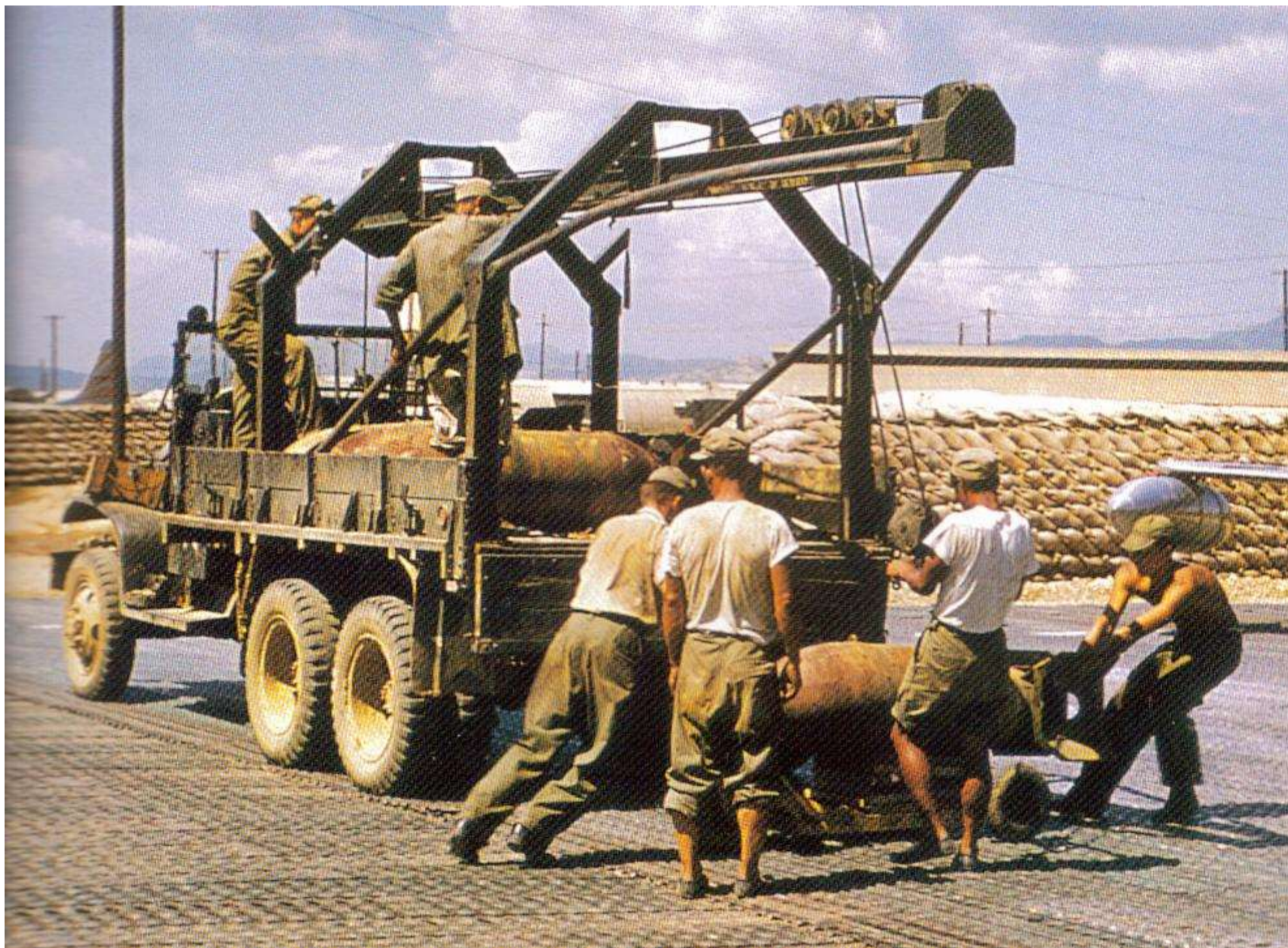
Transportér leteckých bomb M27B1 při manipulaci s bombami na zemi
