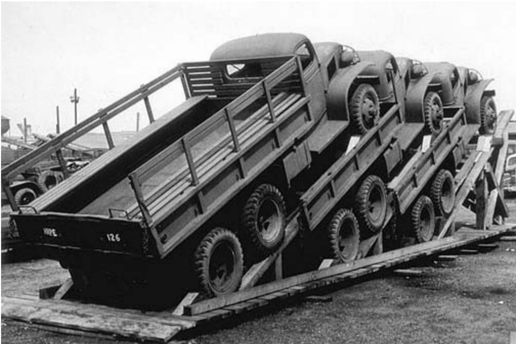
Experimentální sedlové ložení pro lodní přepravu
