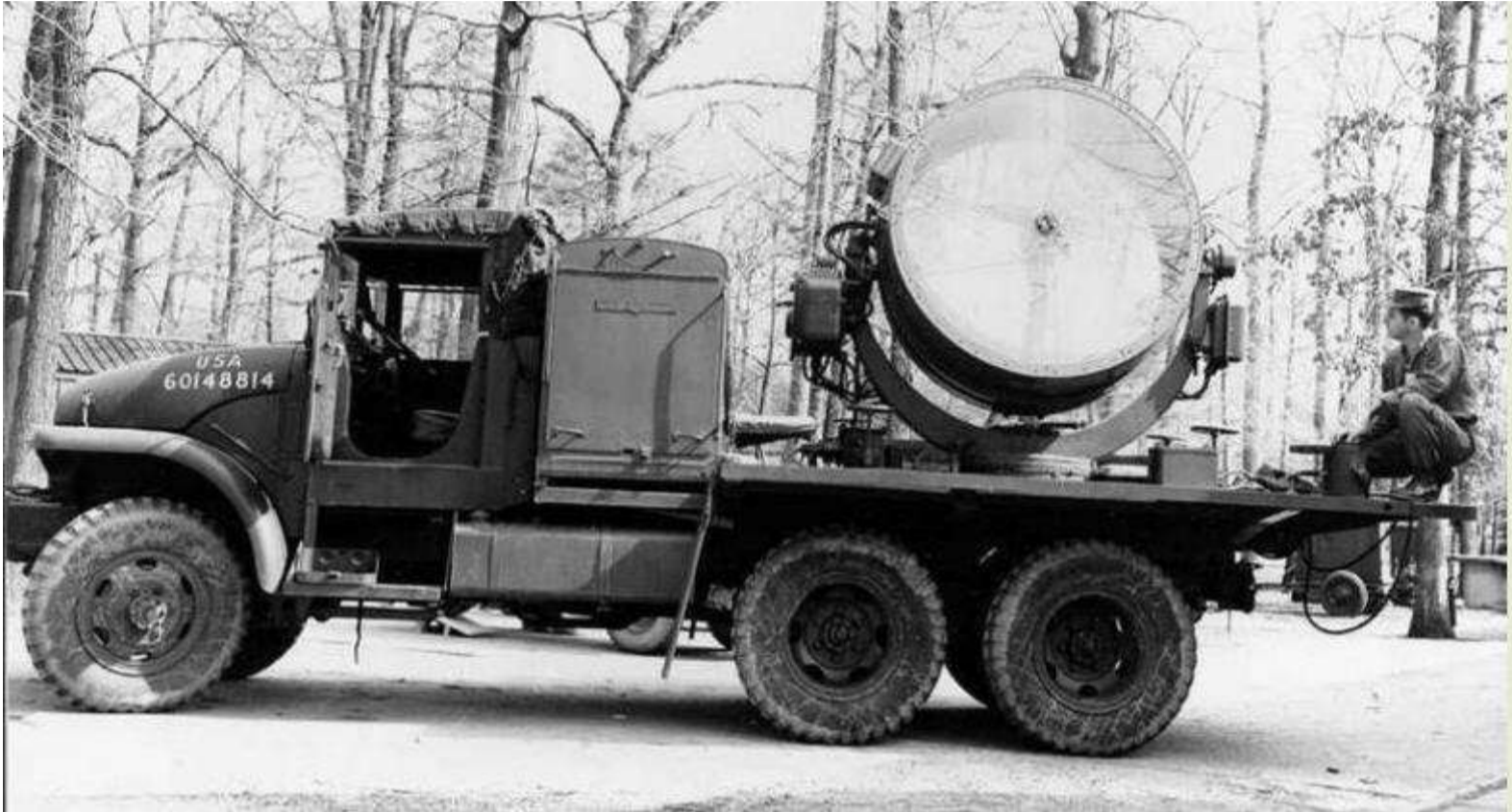
Poválečná konstrukce CCKW 353 s namontovaným protiletadlovým světlometem
