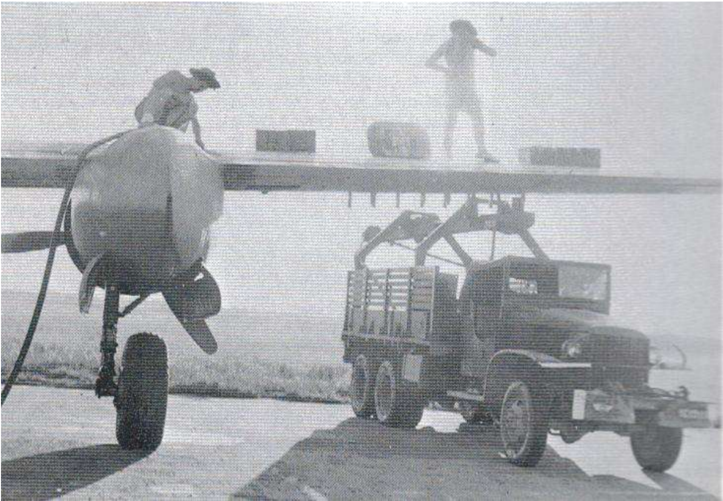
Transportér leteckých bomb M27B1 vyzbrojuje letoun B-26 Invader v Korei
