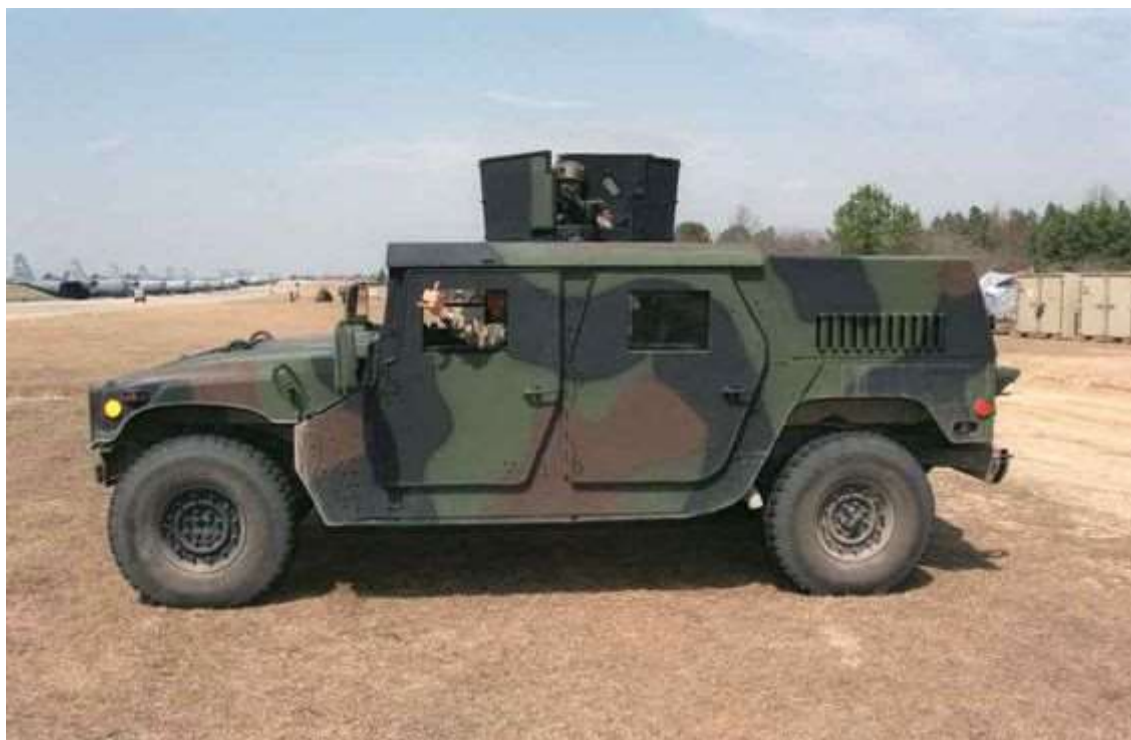
HMMWV ve verzi M1116 s věžičkou chránící stojícího střelce
