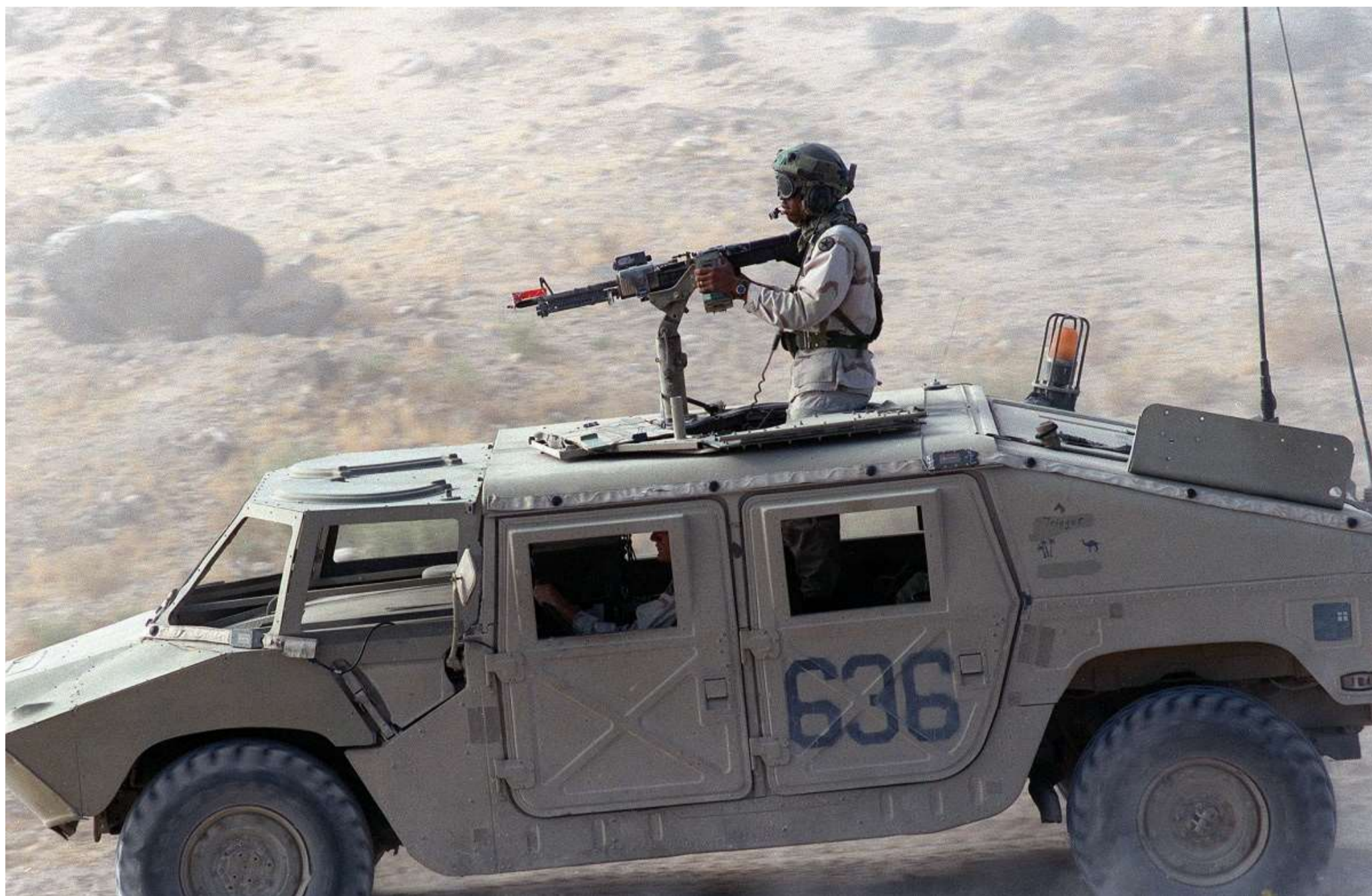
HMMWV ve verzi VISMOD napodobující průzkumný OT BRDM-2
