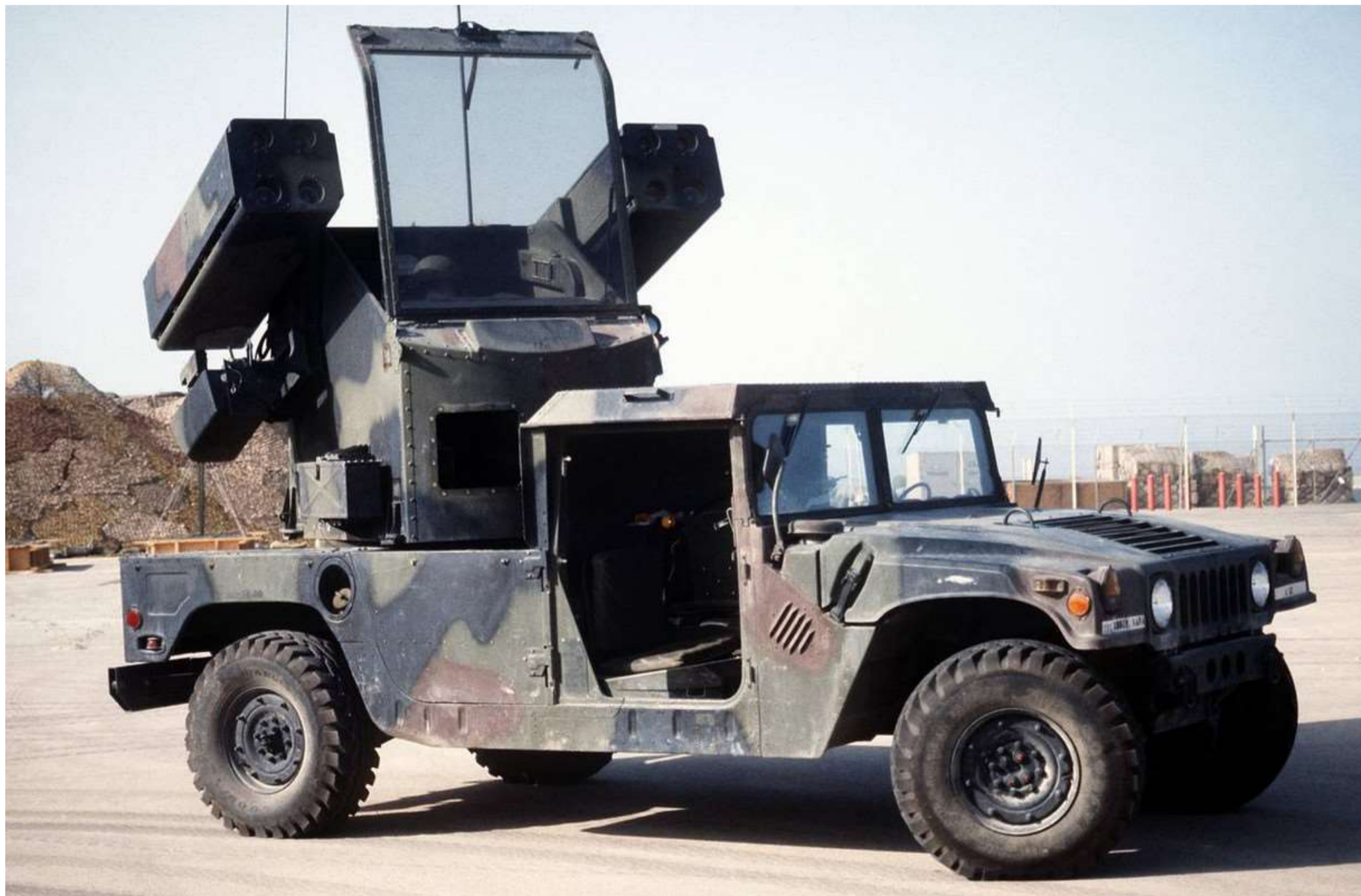
Protiletadlový systém Avenger. Na snímku je dobře vidět otevřený kryt stanoviště operátora střel Stinger
