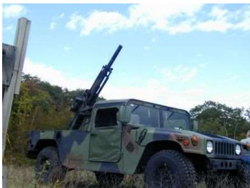
HMMWV vw vverzi Scorpion s automatickým minometem 2B9 ráže 82 mm
