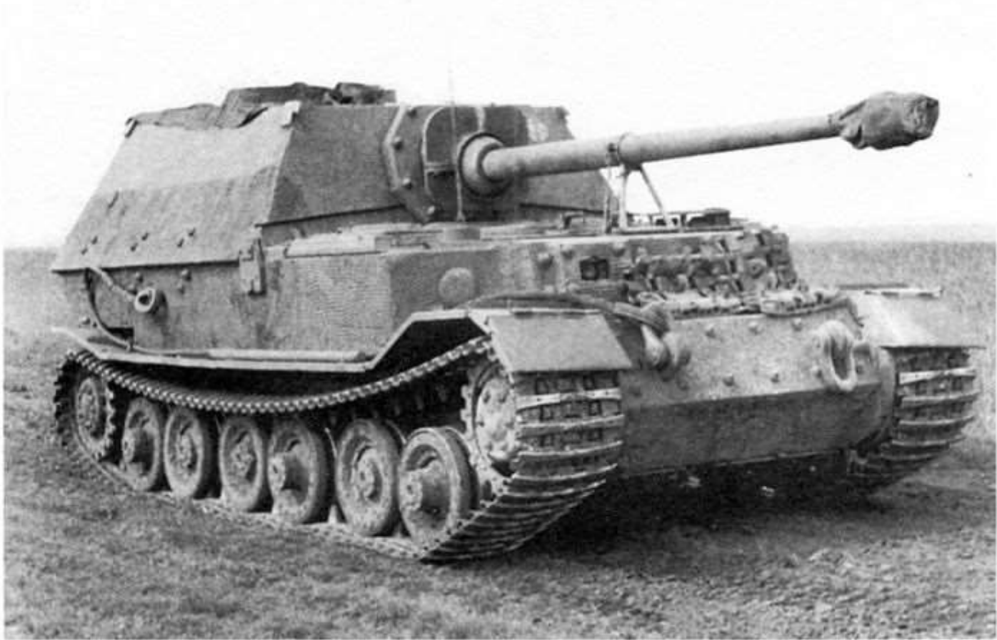
Modernizovaný Elefant z 3. roty 653. praporu těžkých stíhačů tanků. Antimagnetická pasta Zimmerit překrývá stěnu nástavby do poloviny výšky
