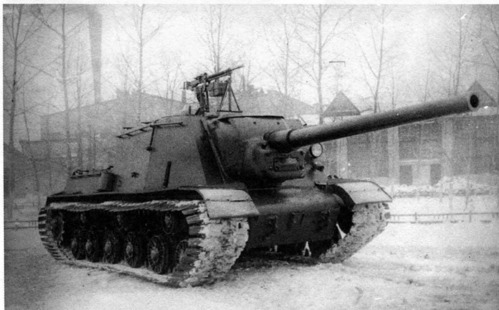
Артсамоход ИСУ-122 с опытной установкой зенитного пулемета ДШК и уширенными гусеницами
