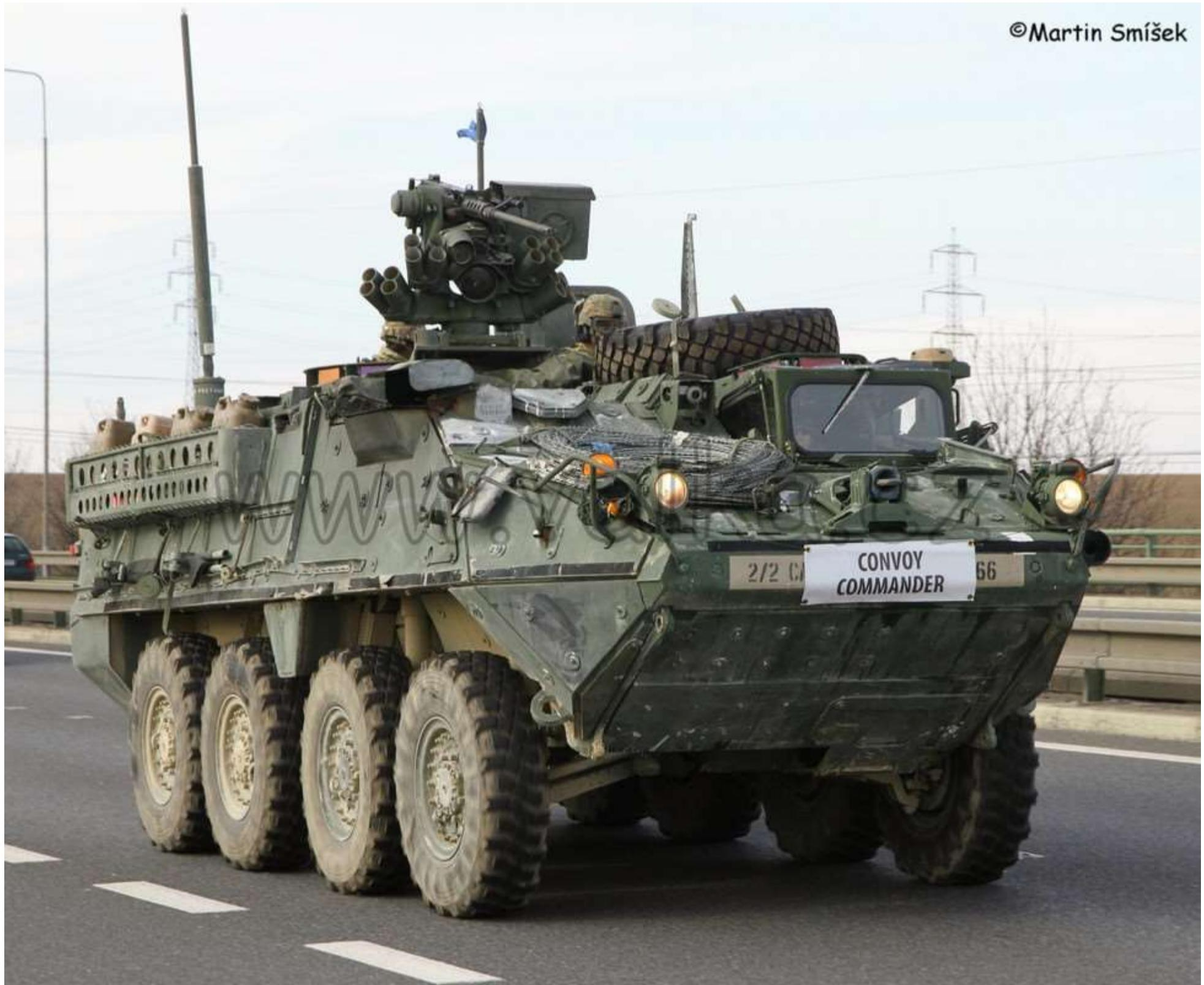
Velitelské vozidlo je určeno příslušníkům velitelského sboru od praporu po brigádu a disponuje soupravou spojovacích prostředků podle stupně ve struktuře velení. Osádku tvoří dva vojáci obsluhující vozidlo a čtyři operátoři obsluhující radiokomunikační přístroje. Vozidlo této verze bývá standardně vybaveno klimatizací a vyzbrojeno modulem „Protector“ s kulometem M2.
