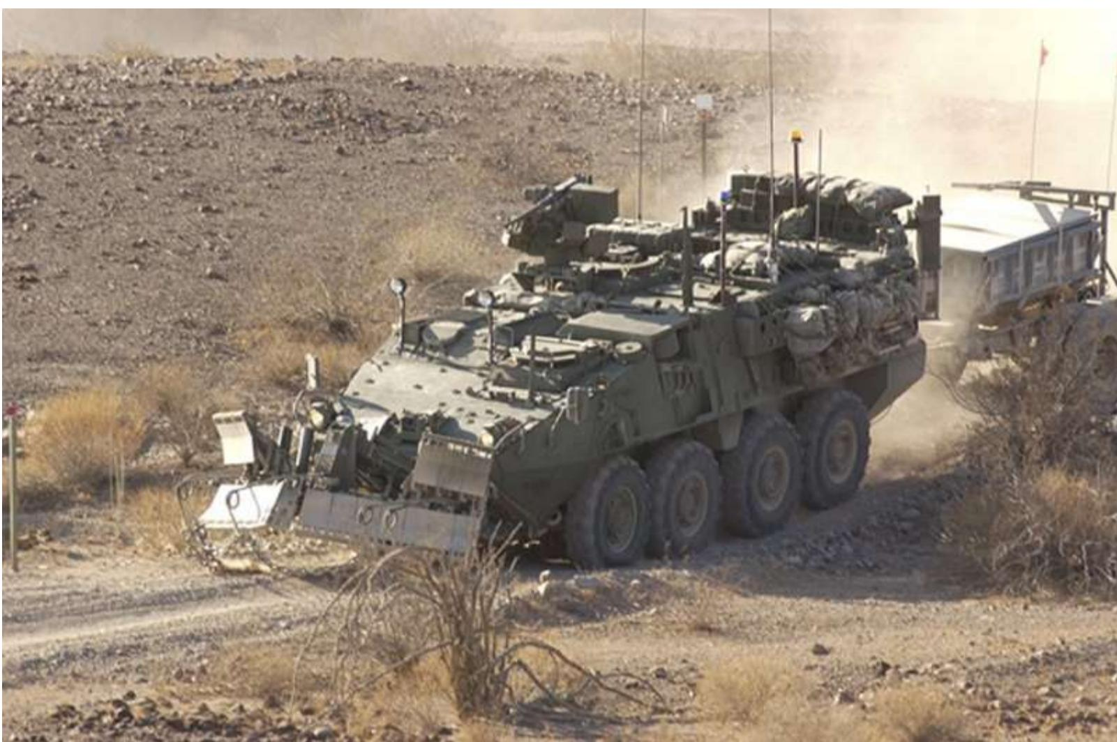
Vozidlo ženijního družstva je určené k transportu a podpoře ženijních oddílů. Jeho osádku tvoří dva vojáci, přepravovaná skupina ženistů může mít devět členů. Na transportér lze namontovat mechanický odminovač, případně buldozerovou radlici.
