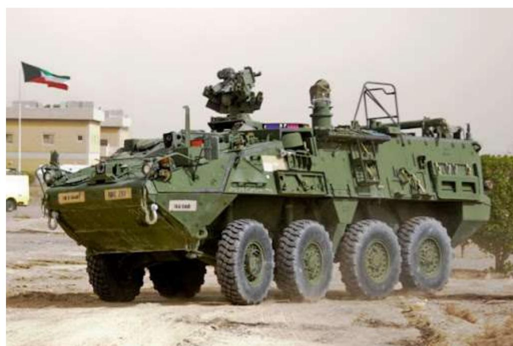
Vozidlo radiačního, biologického a chemického průzkumu bylo do služby zařazeno v roce 2006. Jako jediné ze všech verzí Strykeru je vybaveno systémem ochrany před účinky zbraní hromadného ničení - uvnitř transportéru je např. udržován přetlak. Čtyřčlenná osádka disponuje přístroji na zjišťování bojových chemických látek, detektory radioaktivního záření a zařízením na odběr vzorků kontaminované půdy, vody a vzduchu.
