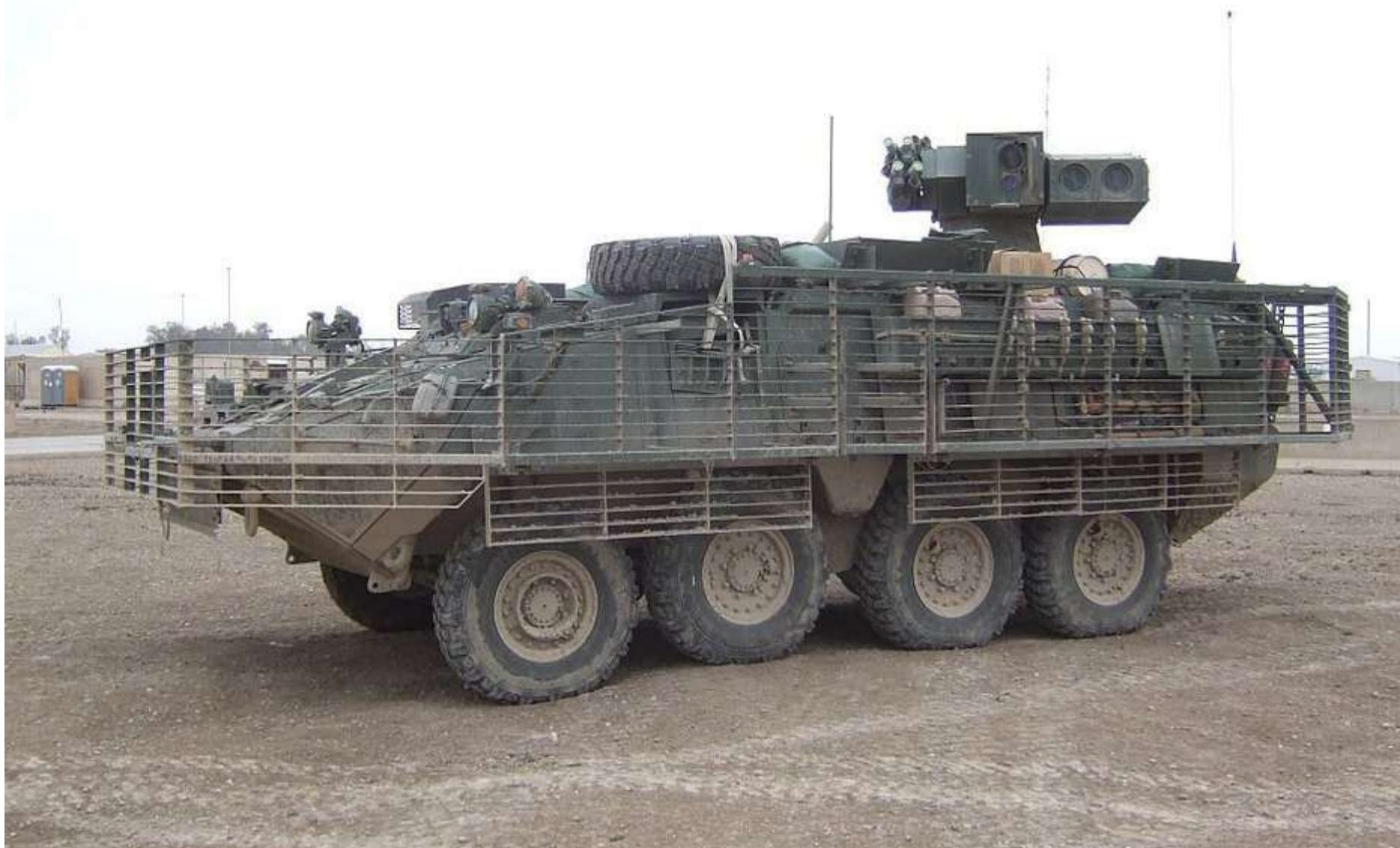
Protitankové vozidlo s PTŘS je určeno k protitankové obraně i podpoře útočící formace Strykerů ICV (fakticky jde o raketový stíhač tanků). Jeho primární výzbroj tvoří výsuvné odpalovací zařízení se dvěma protitankovými řízenými střelami TOW 2B a zaměřovačem ITAS (Improved TOW Acquisition System). Nabíjí se manuálně zevnitř vozidla, což trvá přibližně dvě minuty. K bezprostřední obraně tohoto raketového stíhače tanků slouží kulomet M240B nebo M2.
