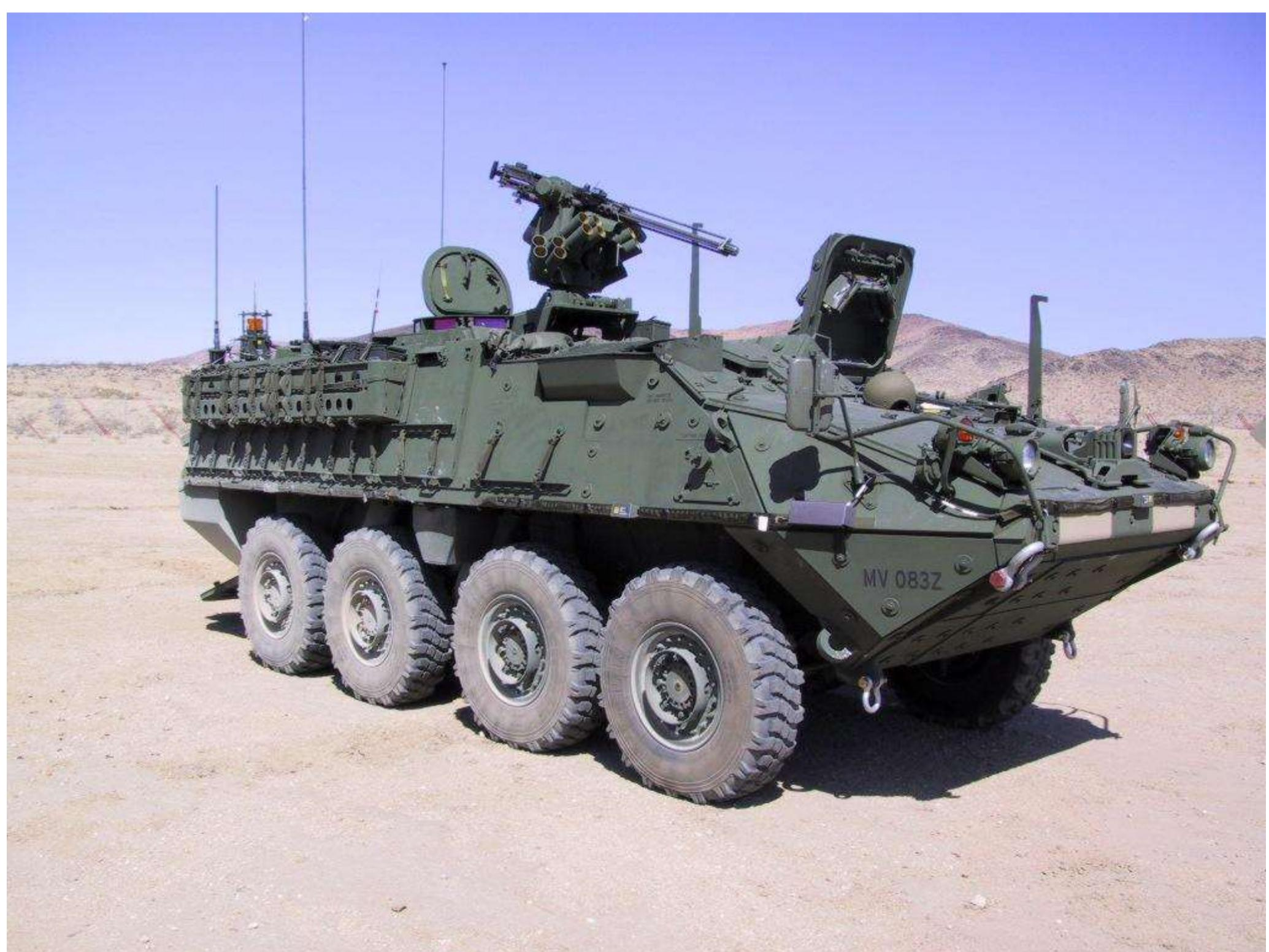
Obrněný transportér je základní verzí vozidla Stryker určenou k přepravě devítičlenného družstva. Vojáci jsou převáženi uvnitř výsadkového prostoru, kde sedí naproti sobě zády k bočním stěnám vozidla. Na pravé straně jsou čtyři místa, na levé straně pět míst. Velitel výsadku sedí vedle velitele vozu jako první na levé
