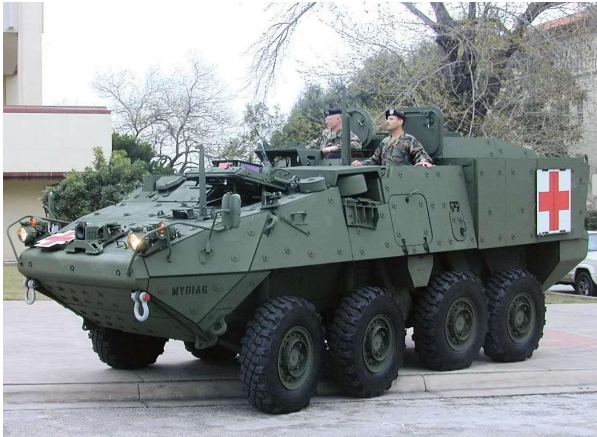
Vozidlo zdravotnického odsunu je nevyzbrojená sanitní úprava sloužící na stupni praporu a roty. Osádku tvoří dva vojáci a zpravidla jeden zdravotník. V ambulanci lze najednou přepravovat bud' čtyři páry nosítka s raněnými, anebo dva raněné ležící a tři sedící.
