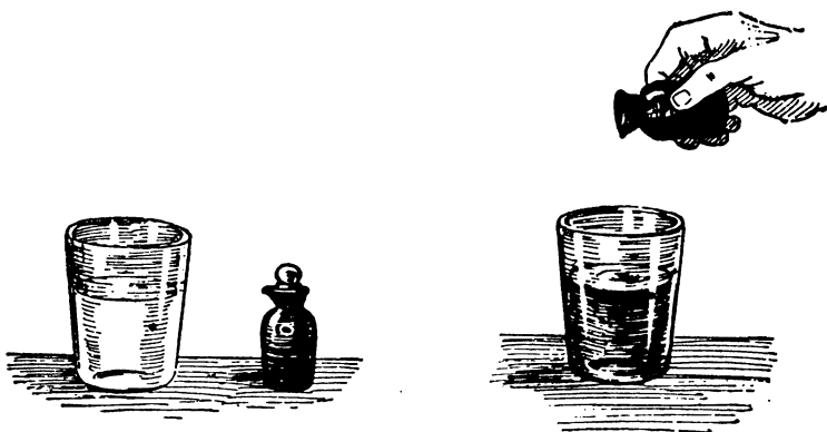
Obr. 85. Zisťovanie prítomnosti škrobu pomocou jódovej tinktúry
