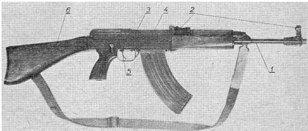
Obr. 4. 7,62mm samopal vz. 58 P (hlavní části)
