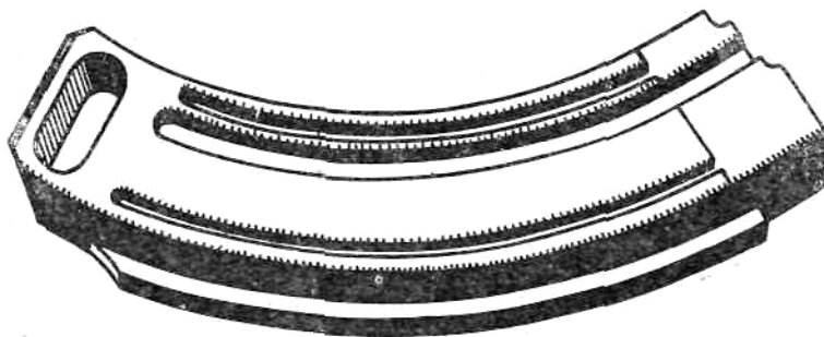
Obr 11. Trn ke kontrole rozměrů a k vyrovnávání pouzdra zásobníku
