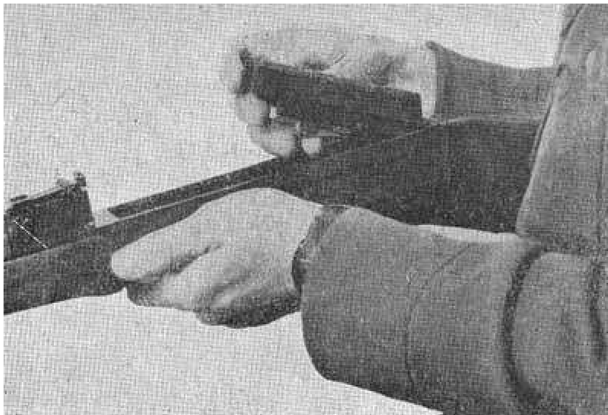
Obr. 45. Vyjmutí závěru
