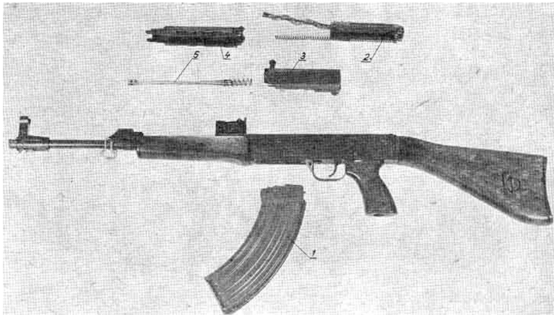
Obr. 42. 7,62mm samopal vz. 58 P částečně rozebraný 1 - zásobník; 2 - vratná ústrojí; 3 - závěr; 4 - nadpažbí; 5 - píst
