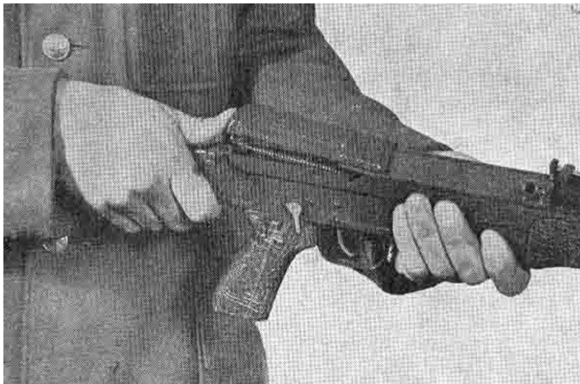
Obr. 44. Sejmutí vratného ústrojí
