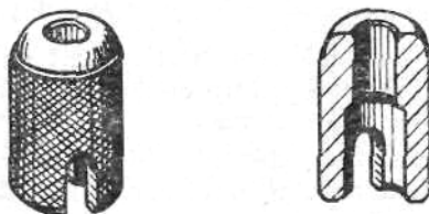
Obr. 13. Pomocné pouzdro pro nasazování vratné zpruhu
