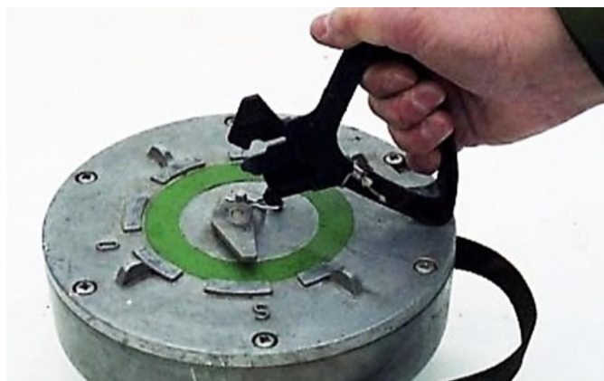
Р и с. 5.39. Выдергивание предохранительной чеки специальным ключом
