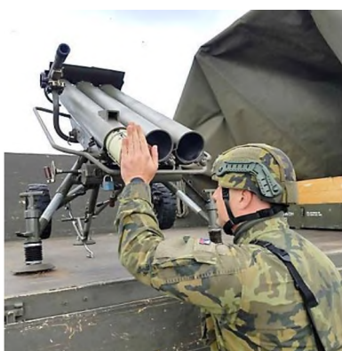
Р и с. 5.47. Загрузка трехствольной пусковой установки MV-3 реактивными снарядами с противотанковыми минами и установка дистанционного минного поля с борта транспортного автомобиля
