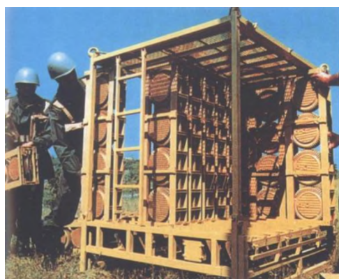
Р и с. 4.11. Вертолетная система минирования DAT (слева – подвесной контейнер, справа – процесс установки мин)
