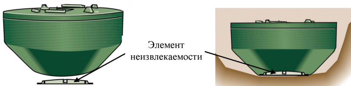
Р и с. 5.38. Установка мины FFV028 в неизвлекаемое положение
