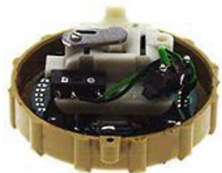
Р и с. 9.5. Устройство взрывателя VS-AR4
