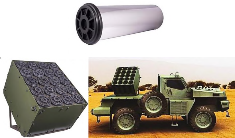
Р и с. 5.16. Контейнер с минами MN-123, пусковой блок и пример его установки на автомобильное шасси
