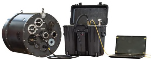
Р и с. 12.32. Программирование аппаратурно-приборного модуля мины Asteria
