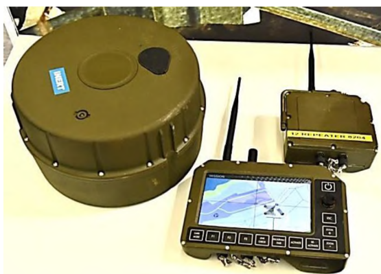
Р и с. 5.10. Противотанковая мина SENTRY ATM с пультом управления и ретранслятором
