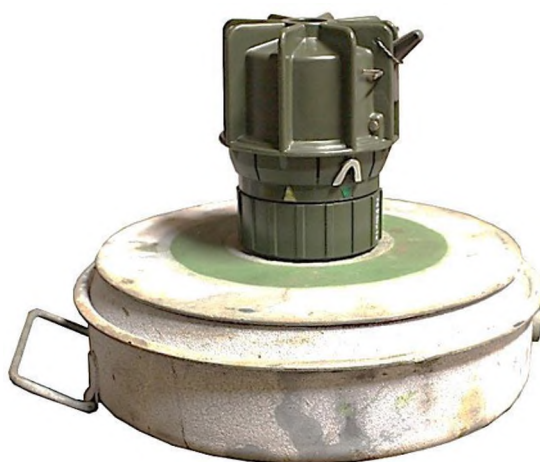
Р и с. 9.12. Взрыватель Stridsvagnsmintändare 4 в транспортном положении, установленный на противотанковую мину с применением переходника
