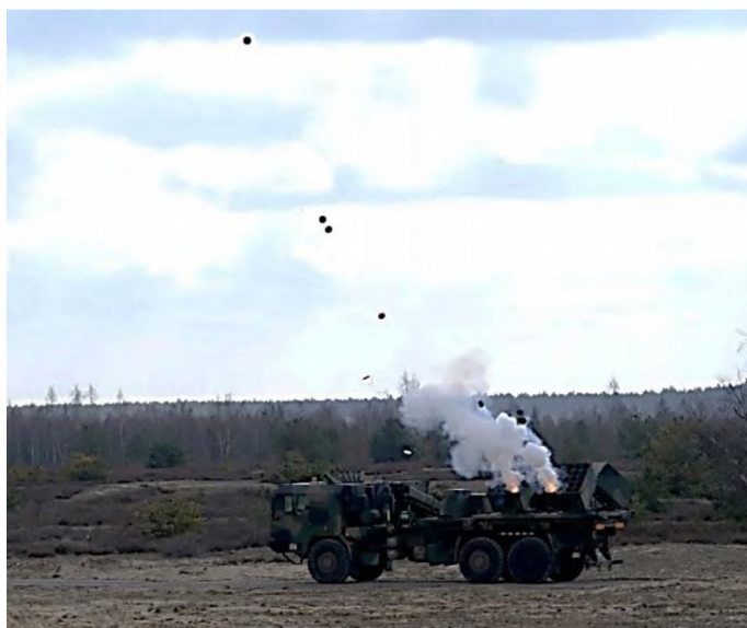
Р и с. 5.17. Установка мин MN-123 наземной системой дистанционного минирования «Баобаб», имеющей четыре пусковых блока
