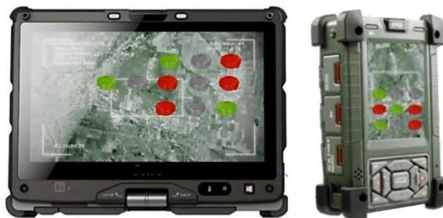
Р и с. 5.8. Центральный и периферийный терминал контроля и управления минами SENTRY ATC
