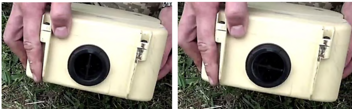
Р и с. 5.29. Положение ручки механизма дальнего взведения мины МІ АС НРD2А2 (слева – механизм выключен, справа – механизм включен)
