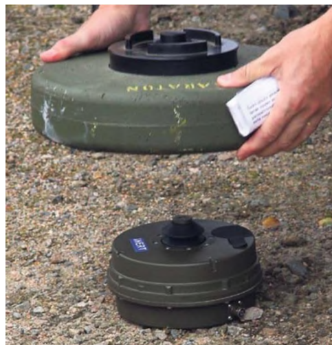
Р и с. 9.19. Взрыватель RMP с противогусеничной миной
