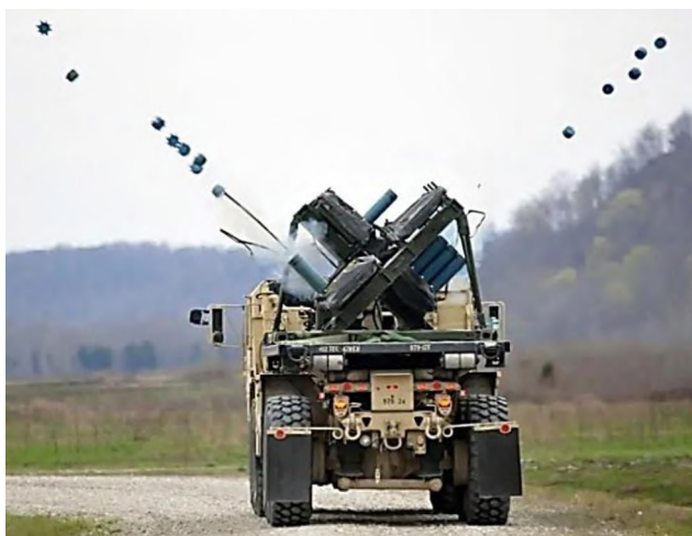
Р и с. 2.21. Установка минного поля с помощью оборудования «Волкэно», смонтированного на автомобильном шасси
