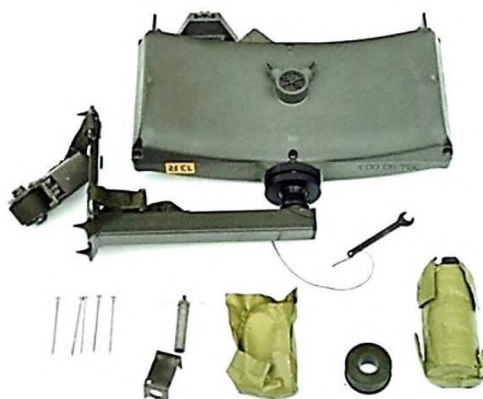
Р и с. 1.29. Состав комплекта современного варианта мины Fordonsmina 13R
