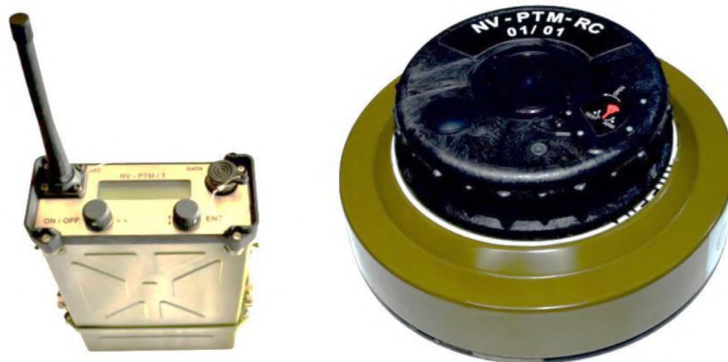
Р и с. 5.59. Общий вид взрывателя NV-PTM-RC с миной ТМ-62М и станцией управления
