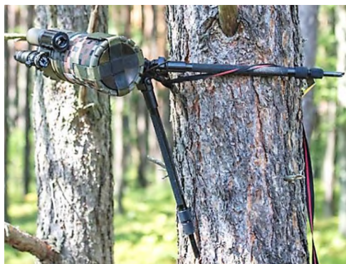
Р и с. 6.16. Мина Tulipan, установленная на стволе дерева
