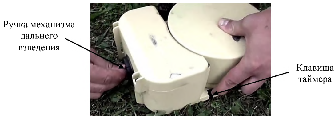
Р и с. 5.28. Элементы управления мины МІ АС НРD2A2
