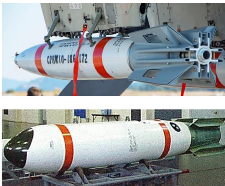
Р и с. 12.20. Общий вид мин Мк 62 (сверху) и Мк 65 (снизу)
