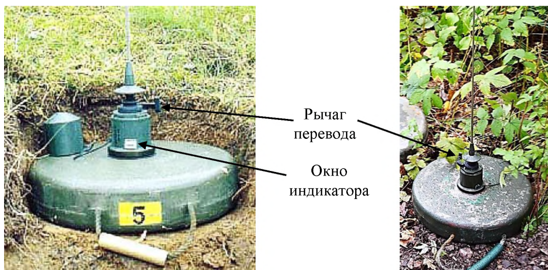
Р и с. 5.42. Мина Stridsvagnsmina 5, снаряженная взрывателем Mintändare 15 в боевом положении (рычаг перевода отжат наружу)
