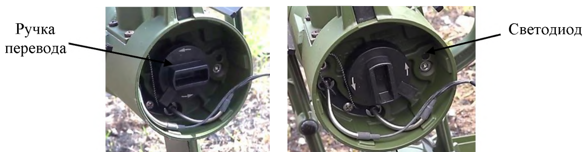
Р и с. 6.25. Ручка перевода режимов работы (справ – ручка в боевом режиме)
