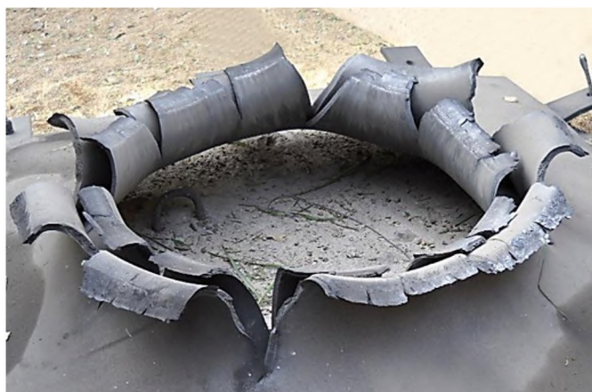
Р и с. 10.3. Пример эффективности мины «Пьовра» по имитатору двухслойного бортового листа корабля
