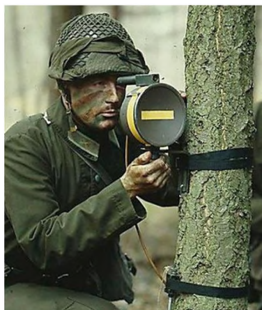
Р и с. 6.9. Прицеливание мины Fordonsmina 14
