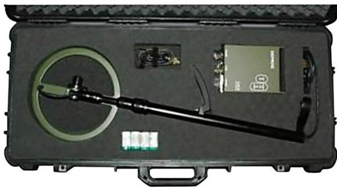
Р и с. 5.4. Устройство Derrog 62 для управления и программирования взрывателей
