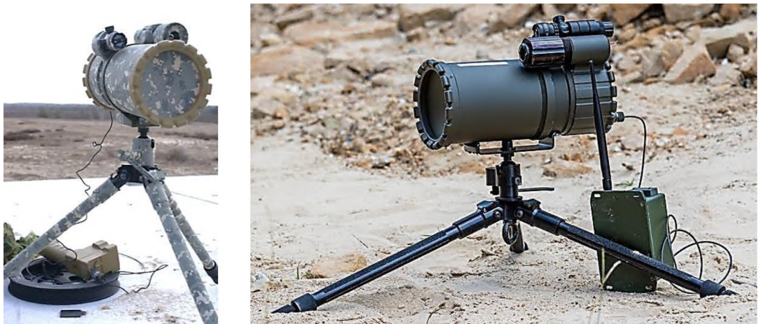
Р и с. 6.14. Мина Tulipan с пультом управления и проводной линией на катушке (слева) и с приемным блоком радиолinii управления (справа)
