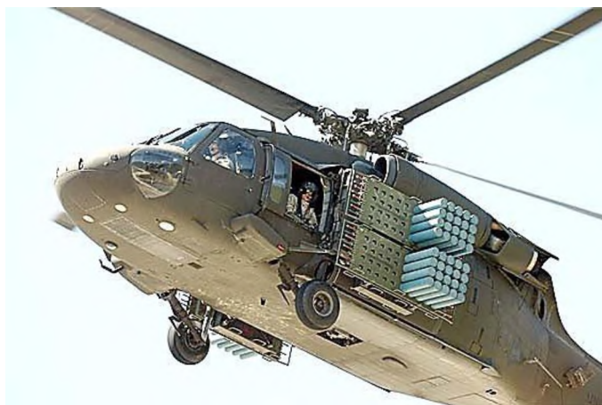
Р и с. 2.23. Оборудование системы минирования «Волкэно» на вертолете
