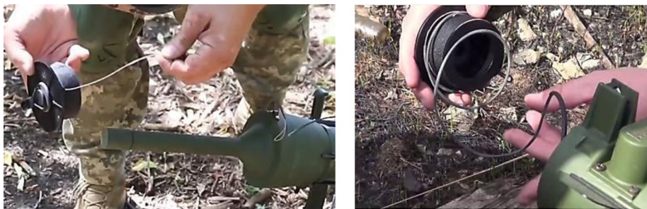
Р и с. 6.23. Разматывание волоконно-оптического датчика цели
