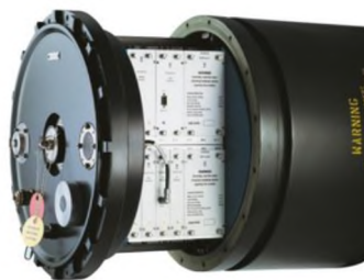
Р и с. 12.29. Аппаратурно-приборный отсек мины MN 102
