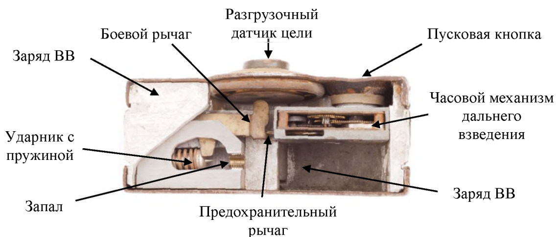
Р и с. 9.2. Устройство мины DM-49
