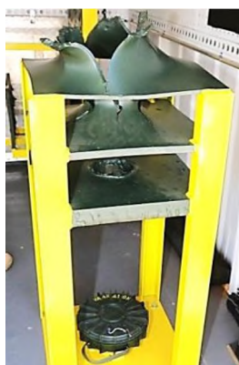
Р и с. 5.12. Эффективность действия мины РМ-87 по броневым листам различной толщины
