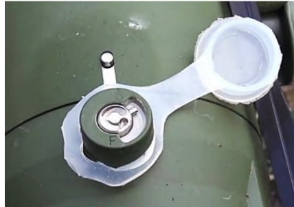
Р и с. 6.22. Механизм переключения режимов работы
