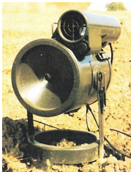
Р и с. 6.34. Общий вид мины МІ АС АН F1 с инфракрасным взрывателем ІRМАН
