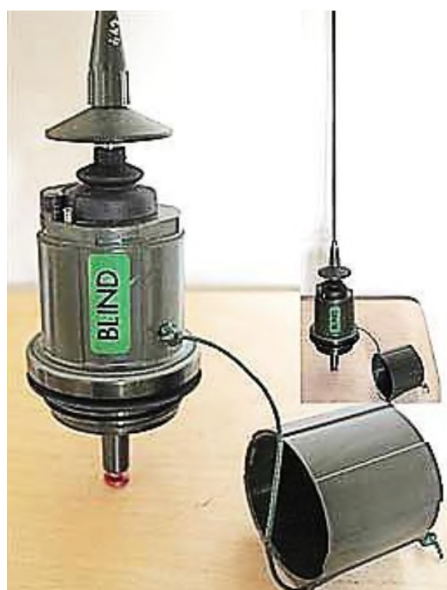
Р и с. 5.40. Взрыватель Mintändare 15 с предохранительным колпачком (показан учебный вариант – надпись «BLIND»)
