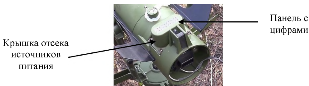
Р и с. 6.26. Панель учета остаточного ресурса источника питания
