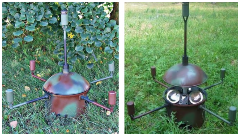
Р и с. 8.1. Общий вид мины IMZR-11 (слева – в режиме ожидания, справа – в режиме «цель обнаружена»)
