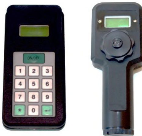
Р и с. 10.12. Программирующие устройства PMDM – L (слева) и PMDM – UW (справа)
