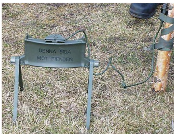
Р и с. 1.8. Мина Truppmiina 12B, установленная со штатным взрывателем натяжного действия в управляемом варианте
