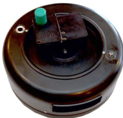
Р и с. 10.10. Практический вариант мины MDM-5 с установленным гидроакустическим маяком системы Dragan
