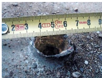
Р и с. 5.54. Эффективность кумулятивного заряда взрывателя АТМФ-07 по броневому листу
