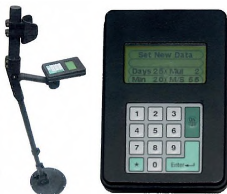
Р и с. 5.64. Устройство ATM-900 P для поиска и программирования мины ATM-900 (справа – вид панели управления крупным планом)
