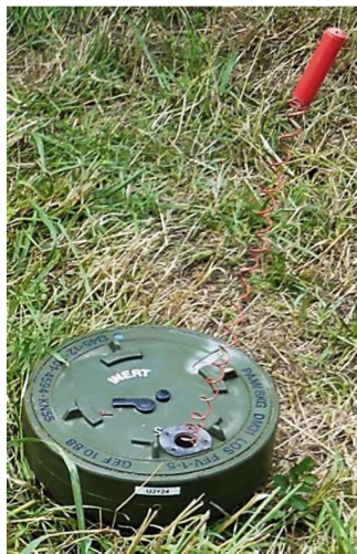
Р и с. 5.33. Отстрел маркерного устройства мины DM31
