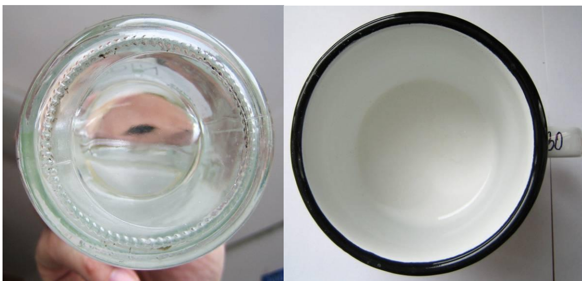
Foto č. 15, 16 Výluh ze smaltového nádobí po 30 hodinách vaření
