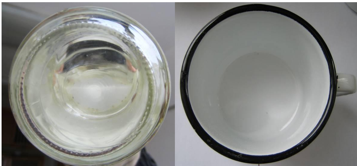
Foto č. 11, 12 Výluh ze smaltového nádobí po 1 hodině vaření
