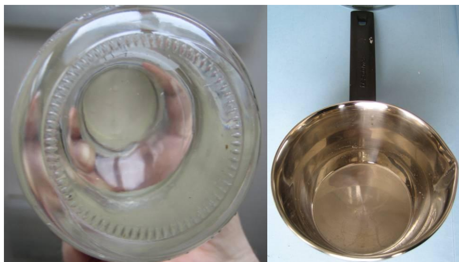
Foto č. 7, 8 Výluh z nerezového nádobí po 5 hodinách vaření
