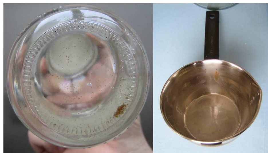
Foto č. 9, 10 Výluh z nerezového nádobí po 30 hodinách vaření
